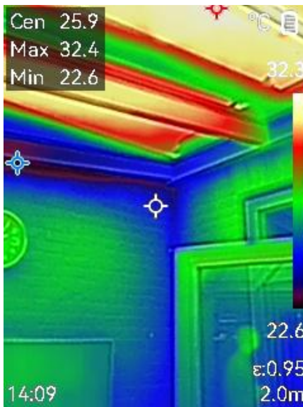
Aansluiting serre tegen oorspronkelijke achtergevel (zie opmerking 3 bij 'geconstateerde naden en kieren' in lekcheck verslag)
